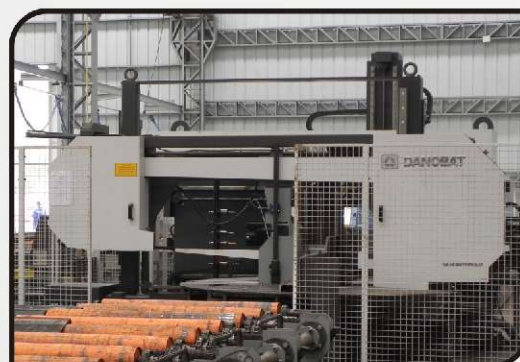
Sistema automatizado para corte, furação e marcação de perfis
