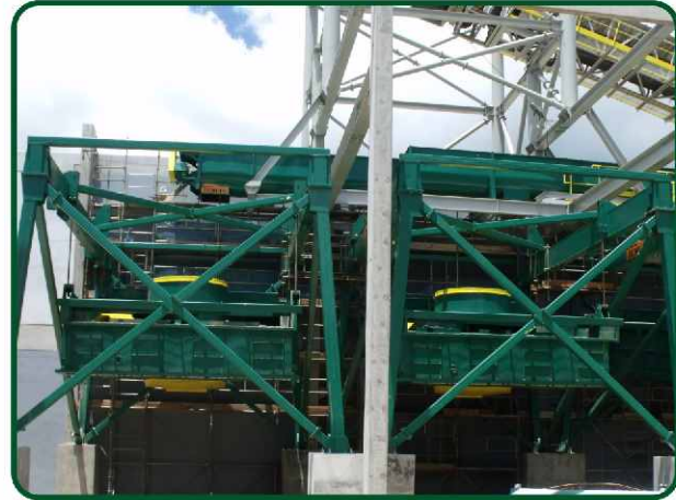
Oscilating Screen - DPO / Peneira Oscilatória
